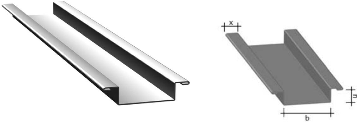
Rigips Hutdeckenprofile sind korrosiongeschützte Metallprofile, die zur direkten Befestigung von Bekleidungen in Gipsplattensystemen dienen. Auch geeignet zur Ausbildung von Dachgeschoss-bekleidungen. Rigips Hutdeckenprofile ermöglichen besonders schlanke Aufbauten und werden aus Stahlblech nach DIN EN 10327 gefertigt.
