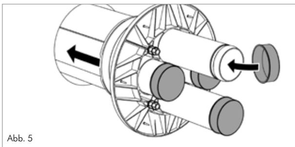
Vor Montage der Außenabdichtung sind die Schutzkappen zu entfernen.
