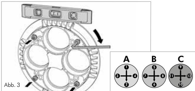
Ankerplatte bündig an die Wand schieben und ausrichten. Die Ausrichtung der Ankerplatte und Anordnung der einzelnen Gewerke ist variabel möglich, sollte aber mit dem zuständigen Netzbetreiber abgestimmt werden!
