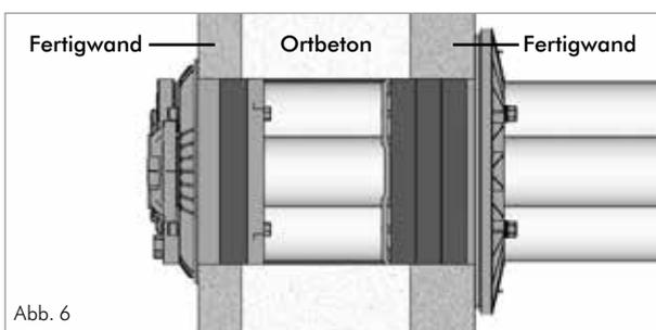
Bei Doppel-/Elementwänden schieben Sie die Außenabdichtung Quadro-Secura® Nova 1/breit über die Hülrohr der Mehrsparte in die Kernbohrung, bis die Lamellendichtung auf der Wandoberfläche (Weiße Wanne; WU-Betonkernbohrung) bzw. an der Hautdichtung (Schwarze Wanne) umlaufend anliegt.
