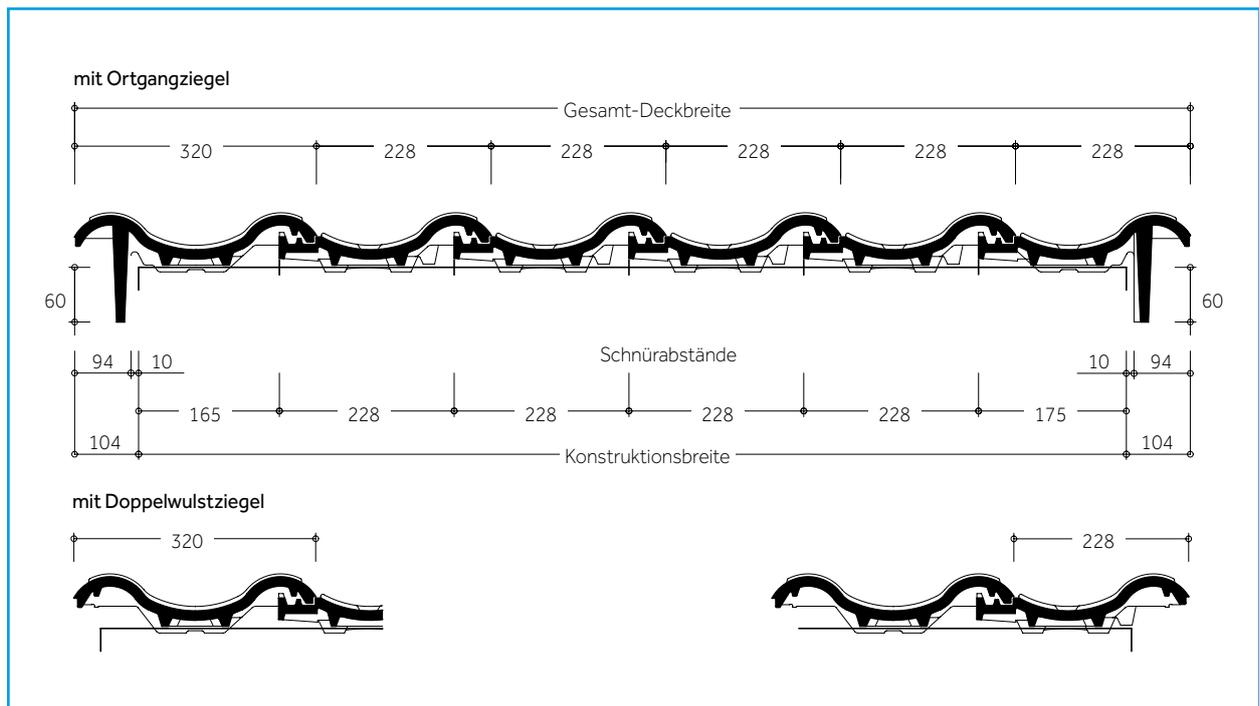
Konstruktionsbreite = jeweils Schnürabstand Ortgang rechts + Dachziegel + Ortgang links
