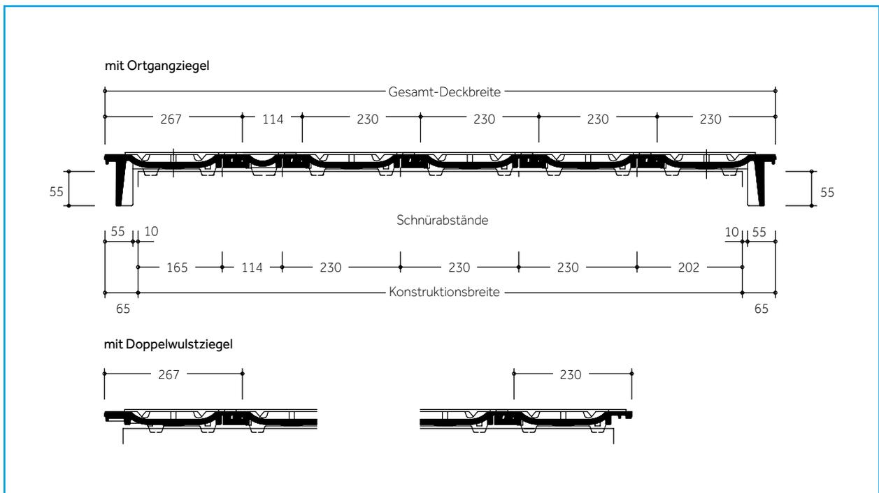
Konstruktionsbreite = jeweils Schnürabstand Ortgang rechts + Dachziegel + Halber Dachziegel + Ortgang links
