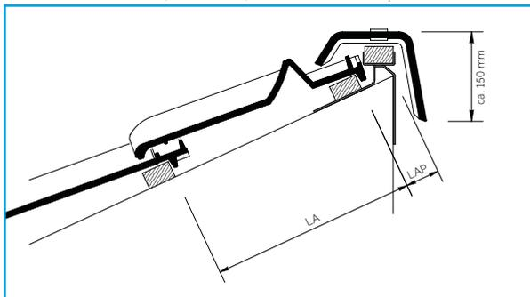
Lattenabstand-Pult (LAP) Uni-Pult mit Firstanschlussziegeln [mm]\* (Dachneigungsbereich: 10° – 45°)
