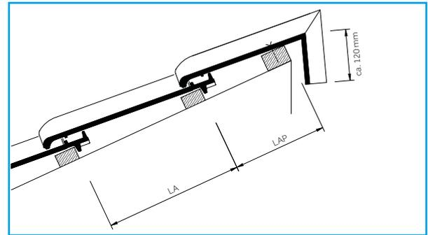
Lattenabstand-Pult (LAP) Uni-Pult mit Flächenziegeln [mm]\*
