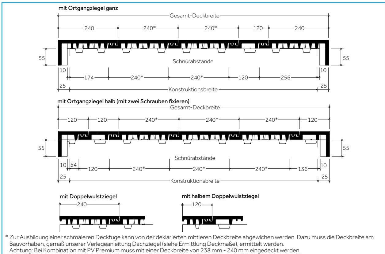
1) Konstruktionsbreite = jeweils Schnürabstand ganzer Ortgang rechts + Dachziegel + Halber Dachziegel + ganzer Ortgang links
