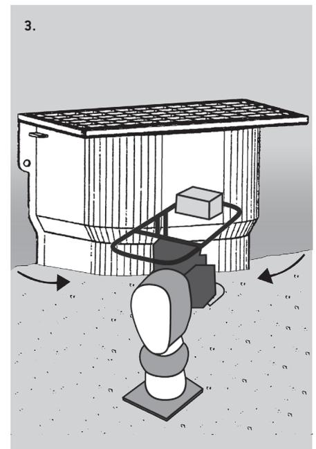
**3.** Bei der Verfüllung darauf achten, dass als Verfüllmaterial nur homogenes Material (z. B. Kies-Sand-Gemisch) verwendet und lagenweise verdichtet wird (zuerst an den Seitenwänden, dann an der Längsseite). Bei schweren Verdichtungsgeräten Sicherheitsabstand zum Lichtschacht halten. Erst nach erfolgter Verdichtung ist der Lichtschacht begehbar. **Beim Verfüllen bitte die Vorschriften der DIN 18300 einhalten.**
