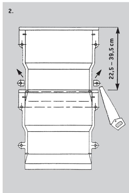
**2.** Den Lüftungsschacht montieren. Bei Bedarf die unteren Laschen abtrennen..
