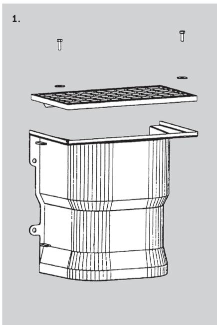
**1.** Vor Montage Gitterrost einlegen und Geländeoberkante markieren. Bohrungen anzeichnen und bohren (4 x Ø 12 mm, 90 mm tief). Bohrlöcher ausblasen und Dübel F12 setzen.
