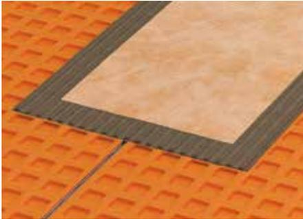
bettmörteln erfolgen. Der Estrich wird durch DITRA 25 vor Feuchteintritt an der Oberfläche geschützt. Calciumsulfatestriche sind feuchtigkeitsempfindlich, so dass der Estrich vor weiterer Durchfeuchtung, z. B. rückwärtiger Feuchtebelastung, zu schützen ist.
