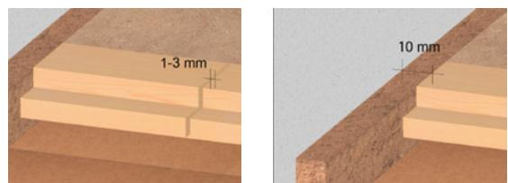
GUTEX Thermosafe-nf im Verbund verlegen. Das Reststück einer Verlegereihe kommt an den Anfang der nächsten Reihe.
